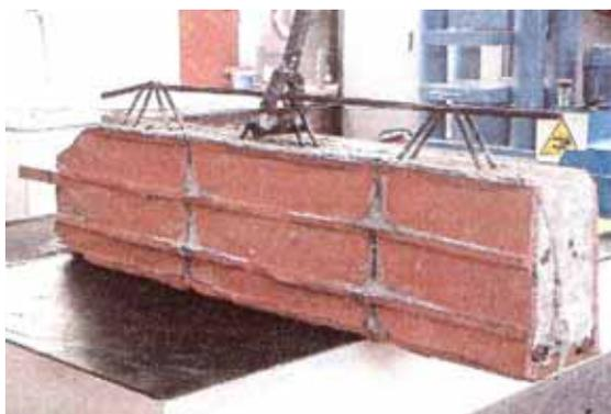
Le prime rotture si hanno al carico di 111,8 daN (distacco di due staffe), concentrati in un solo punto sul nodo staffa-ferro superiore
